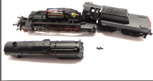
Ausbau alter Motor Take out old motor
